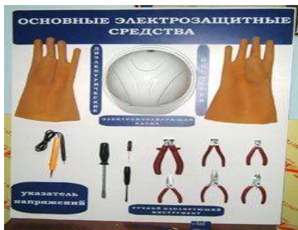
Рис. 76. Основные изолирующие электрозащитные средства
